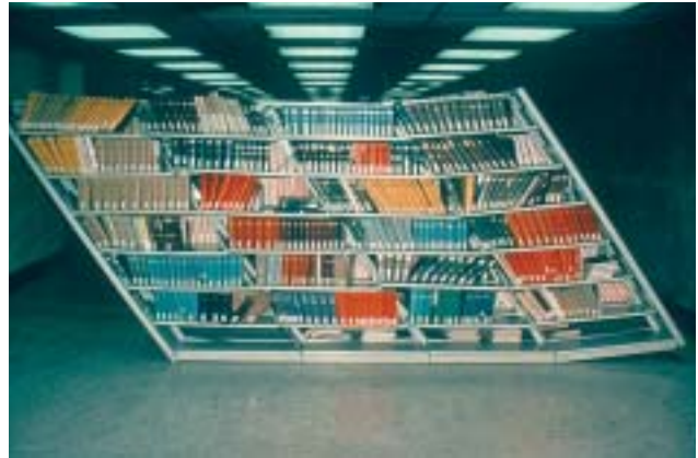
35/6 Bücher stellen eine beträchtliche Masse dar, sodass kräftige Verankerungen und Aussteifungen der Gestelle in beiden Hauptrichtungen erforderlich sind (Whittier Narrows 1987).
