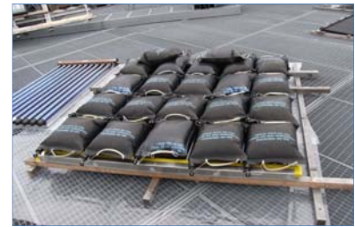
Abb. 3 Belastungstestanlage mit Wasser-/Sandsäcken. Günstig und einfach.
