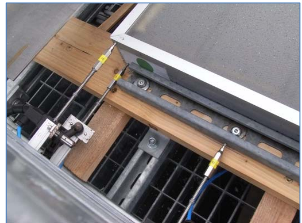
Abb.7 Distanzsensoren werden an kritischen Punkten platziert um die Verformung des Prüflings unter Last zu messen
