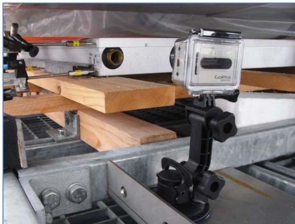
Abb. 6 Frei platzierbaren Weitwinkelkameras zeichnen den Verlauf der Prüfung auf.
