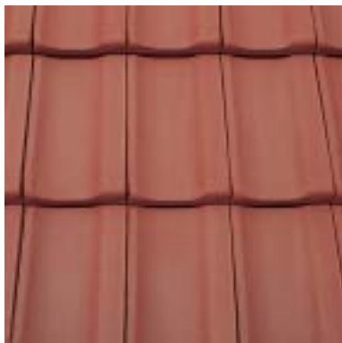
Flachziegel (Jura-Ziegel) Lattweite: ca. 32 – 37 cm Deckbreite: ca. 21 – 22 cm Ziegelbedarf: ca. 13 Stk./m 2
