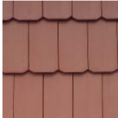
Falzbiberziegel (in verschiedenen Schnittarten lieferbar) Lattweite: ca. 30 cm Deckbreite: ca. 17 cm Ziegelbedarf: ca. 19 – 23 Stk./m 2
