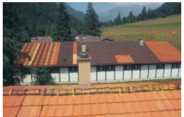
Freilandversuche in voralpinem Klima, wobei über 100 Produktions-Lose langfristig wissenschaftlich überprüft werden können.
