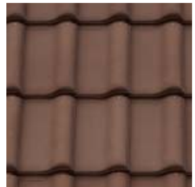
Pfannenziegel Lattweite: ca. 35 – 36 cm Deckbreite: ca. 21 – 22 cm Ziegelbedarf: ca. 13 – 14 Stk./m 2
