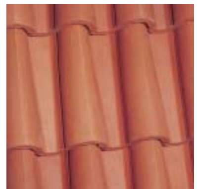
Pfannenziegel, Typ «Römerziegel» oder «Klosterziegel» Lattweite: ca. 35 cm Deckbreite: ca. 19 cm Ziegelbedarf: ca. 13 – 15 Stk./m 2
